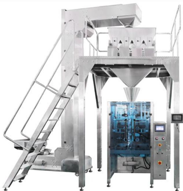
Рисунок 3 – Упаковка кормов в герметичную тару с заданной нерегулируемой газовой средой
