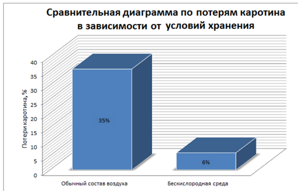
Рисунок 1.7 – Сравнительная диаграмма по потерям каротина в зависимости от условий хранения
