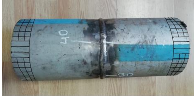
Фрагмент трубы коррозионностойкой жаростойкой размером 160×6 мм из стали 08X18H10T
