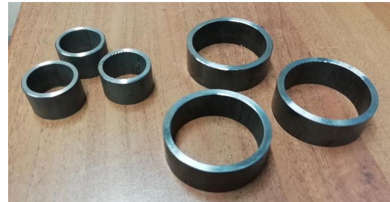
Кольца длиной по 20 мм, из труб размерами 58×4 мм и 32×2 мм
