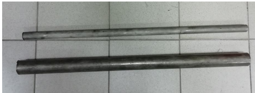
Фрагменты труб размерами 58×4 мм и 32×2 мм из коррозионностойкой жаростойкой стали 08X18H10T
