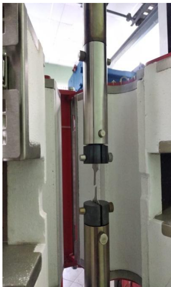
Испытания на растяжение с термокамерой
