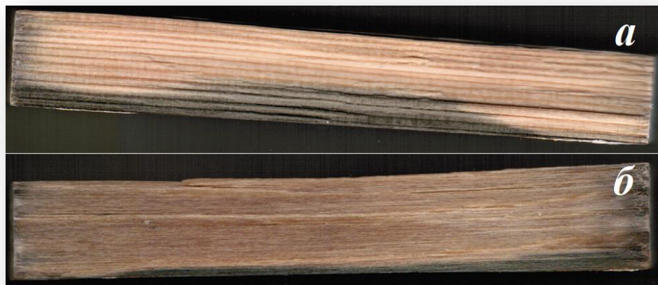
Образцы древесины обработанные СВЧ и пропитанных с закрытыми торцами: а – радиальное направление, б – тангенциальное направление
