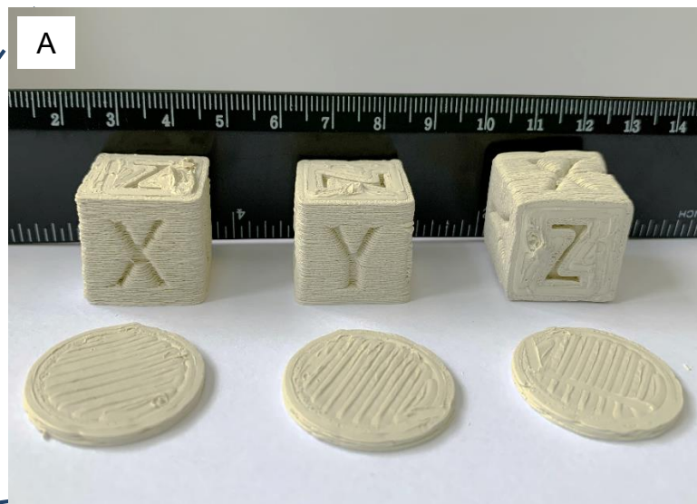
Экспериментальные образцы, полученные методом FDM из разработанного керамополимерного филамента с соотношением 60% Al_2O_3 и 40% PLA.
