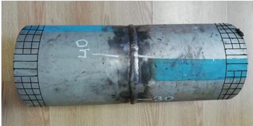
Фрагмент трубы коррозионностойкой жаростойкой размером 160×6 мм из стали 08X18Н10Т
