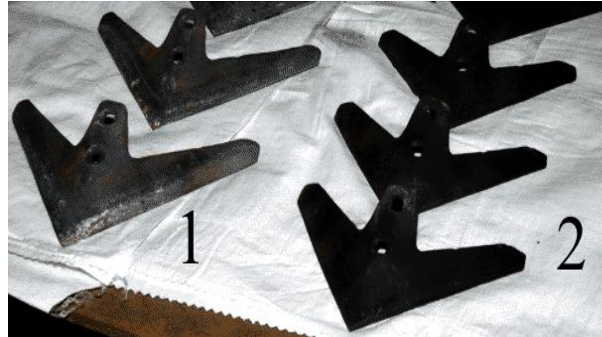
1 - серийная лапа; 2 - плоскорежущая лапа с расчетным профилем крыла
