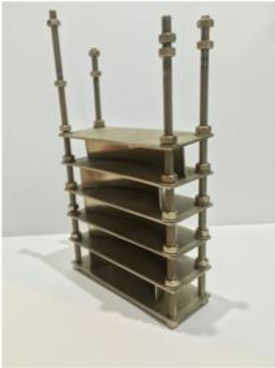
Внешний вид образцов с нанесенным покрытием (Ti-V)N
