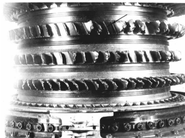
Повреждения ротора и лопатки изд. 25 из сплава ВТ9
