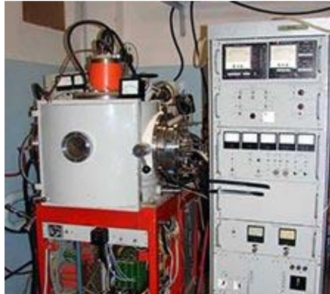
Установка ВУ-2М для нанесения вакуумного ионно-плазменного покрытия (слева)
